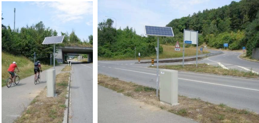
Figure 1: Section de comptage de Hemishofen SH (armoire du compteur avec panneau solaire)
